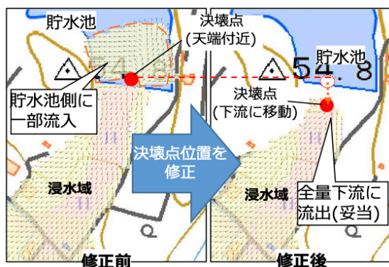
図-6 決壊点位置の典型的な設定ミスの例（「ため池ハザードマップ作成のための浸水想定区域算定マニュアル（案）」より転載）
