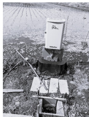
図-2 設置した自動水管理装置
